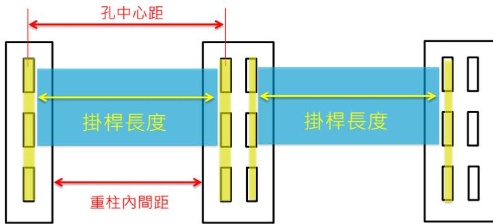
掛桿長度算法1 = 孔中心距 - 5mm (排孔管/重柱)
